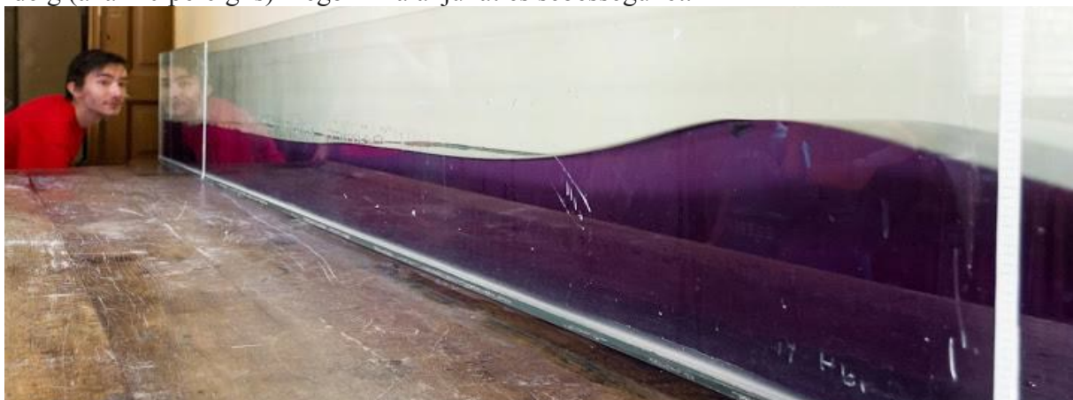
16. ábra Szolitonhullám a víztartályban, az elválasztó fal eltávolítása után, a 2015-ös Kísérletszombaton (saját fotó)
