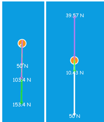
4.15. ábra. Egyirányú és ellentétes irányú erők összeadásának gyakorlása az „eredoero1” szimulációval. A fehér (gravitációs erő) és a lila (külső erő) eredőjét zöld nyíllal jelöli a program.
