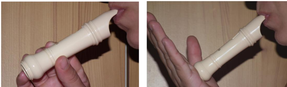
1.10. ábra. Nyitott és zárt síp vizsgálata furulya fejének segítségével.
