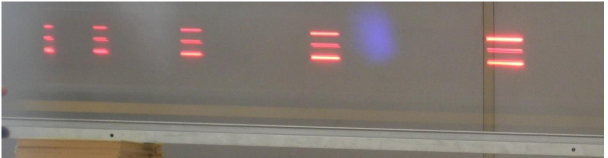
31. ábra: A lejtőn leguruló kiskocsin villogó kerékpárlámpáról készült hosszú expozíciós felvétel
