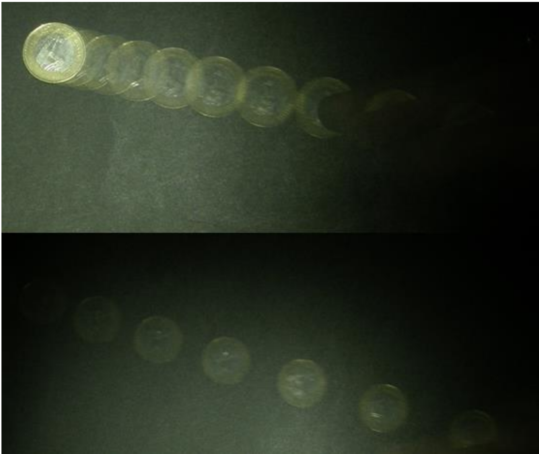
18. ábra: A fekete kartonlapon csúszó pénzérméről készített strobofelvétel
