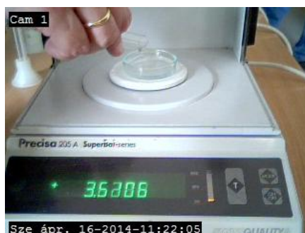
2.14. kép Dietil-éter párolgásának vizsgálata digitális mérlegen webkamerás felvétellel
