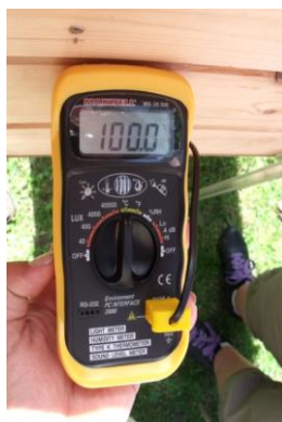
2.12. kép Az aszalótér hőmérsékletének mérése
