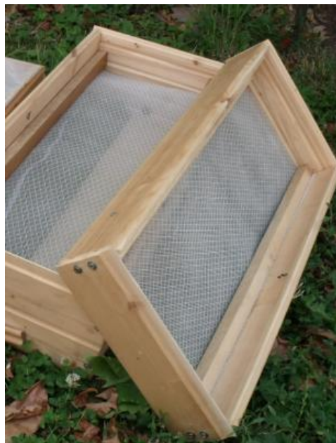
2.2. kép Az aszalótér egymásra helyezhető tálcái
