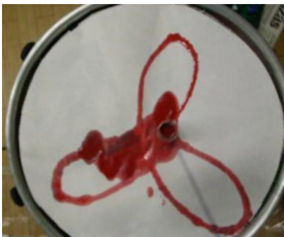
3.5. kép Középpontból és 3.6. kép szélső helyzetből indított Foucault-inga modell trajektóriája.
