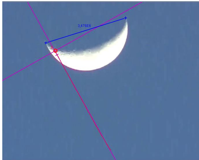
3.34. ábra: a Hold nagyított képe lehetőséget biztosít egy finomabb részlet megragadásához a nyomkövetésnél. A képen a Hold átmérőjét használtuk a megfelelő kalibráláshoz. A koordinátatengely x tengelye a mozgás irányában van felvéve.
