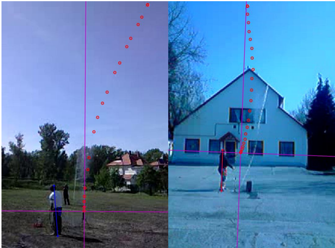
3.2. ábra: a vízrakétáról készült felvételek video analíziseinek pillanatképei.
