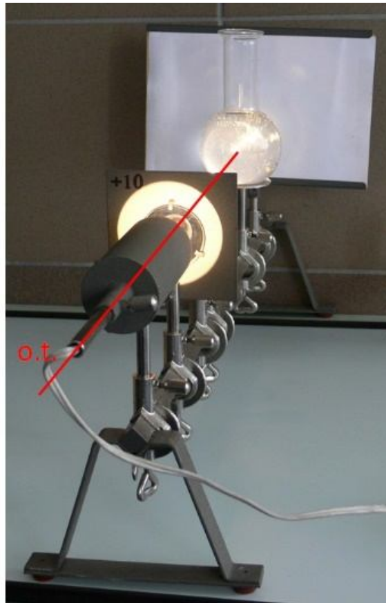
1.7. ábra: gömb alakú vízcseppek fénygyűjtő-képességének vizsgálata párhuzamos fénynyalábbal történő átvilágításkor. A képen jelezve van az optikai tengely.
