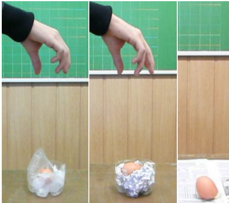
2.10. ábra: a tojás ütközése felfújott lyukacsos nylonzacskóval, lazán összegyűrt alufóliával és az asztallappal.
