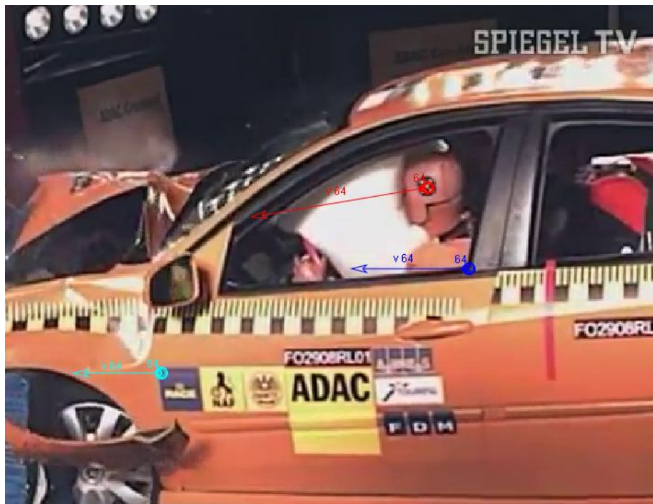
2.7. ábra: Renault Laguna törésteszt-videofelvételének pillanatképe. A mérés kezdetétől számított 64. képkockán láthatók a mérési pontok és a pontok pillanatnyi sebességeinek irányai és relatív nagyságai is.
