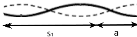
7. ábra, Vonalmenti állóhullám szabad vég esetén
