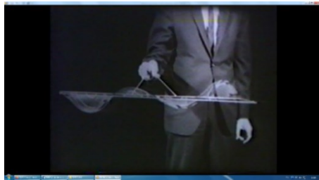
8. ábra, Kétdimenziós állóhullám téglalap alakú kereten
