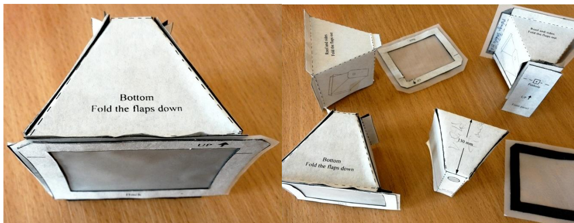
2.34. ábra A nap átmérőjének meghatározásához használt „túlyuk doboz”
