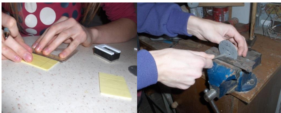
3.14. ábra Készül a CanSat burkolata. A doboz alá furatokat készítünk, hogy a levegő átáramolhasson rajta, és megfelelő hűtést biztosítson az egységnek.
