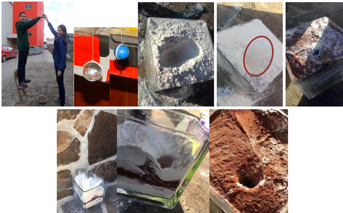
4.6. ábra Könnyű, finom szemcsézettségű anyagokban keletkezett becsapódási minták (forrás: Csősz S, Damokos D, Csia K., Bernád A.M. IX. B. dolgozata)
