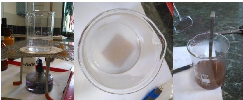
1.10.ábra Radonsugárzás kimutatására használható mérőlap előkészítése a kémia laborban (Kónya K. képei)
