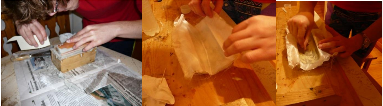
3.27. Így készült a CanSat2015 üvegszálalás burkolata
