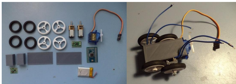
3.29. ábra A rover alkotó elemei és az elkészült modell
