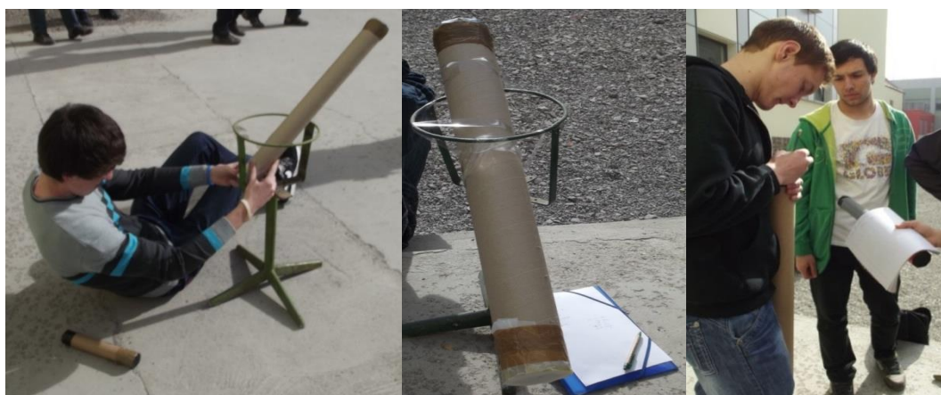
2.31. ábra A Nap látszólagos átmérőjének a mérése
