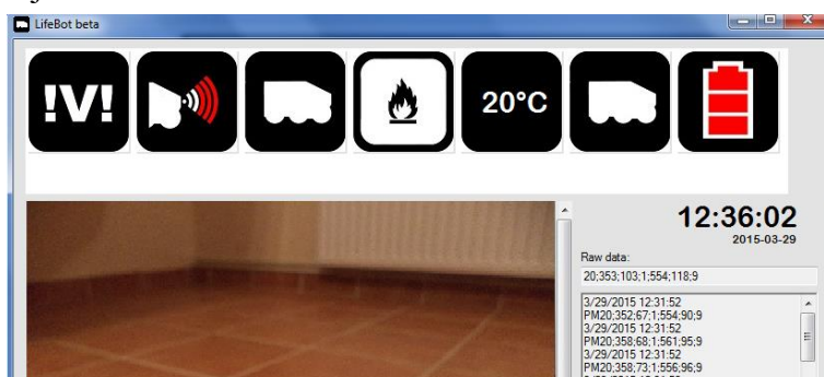
5.10. ábra A számítógép kijelzőjén megjelenő kép a robot adataival és a vizsgált terepről készült kép (forrás: Krecht R. díjnyertes dolgozata)
