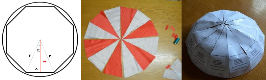
3.36. ábra 12 szelvényes ejtőernyő terve, szabása és a papírmmodell
