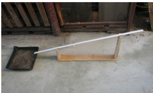
4.2. ábra Kísérleti állvány az állandó becsapódási szög biztosítására (forrás: Blényesi B., Erdélyi Ö. IX. A dolgozata)
