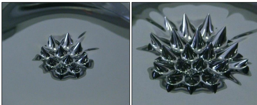
2-13. ábra: Ferrofluidum felszíne különböző erősségű mágneses terek jelenlétében
