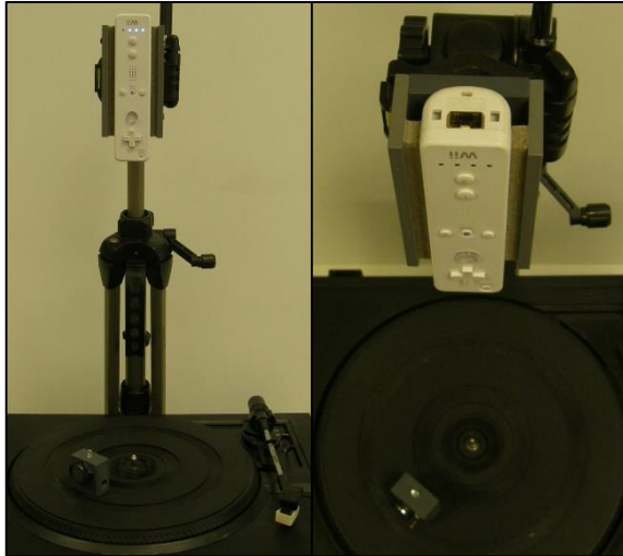
3-19. ábra: Kísérleti összeállítás körmozgás vizsgálatához
