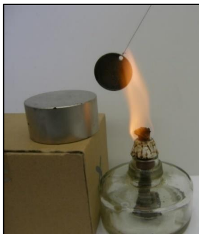
2-9. ábra: A Curie-hőmérséklet kísérleti bemutatása
