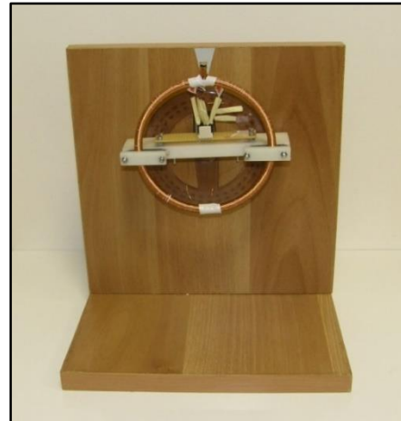
2-37. ábra: Az általunk épített toroidális FCDT
