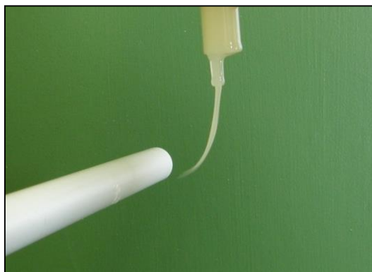
2-18. ábra: Olajból és keményítőből készített ER folyadék feltöltött ebonitrúd mellett
