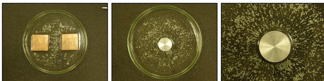
2-16. ábra: Kukoricadara láncosodása elektromos tér jelenlétében
