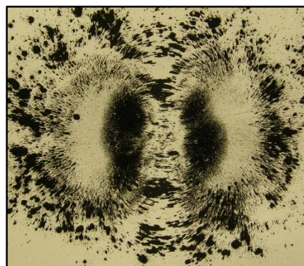
2-10. ábra: Magnetit por láncosodása mágneses tér jelenlétében
