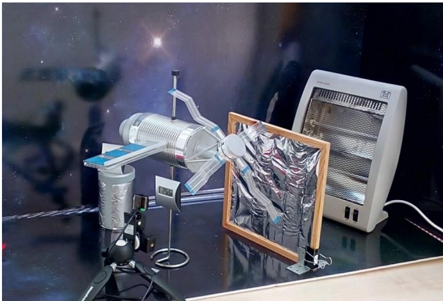
58. ábra Kísérleti összeállítás hőárnyékolás méréshez (diákkísérlet)
