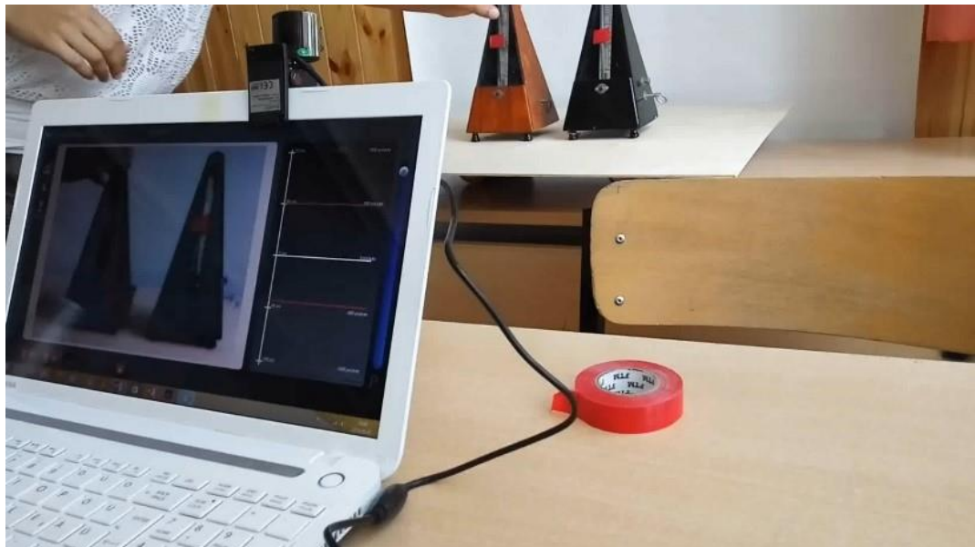
39. ábra Metronókok szinkronizációjának mérési összeállítása és a LABCAM program alkalmazása (forrás: saját kép)
