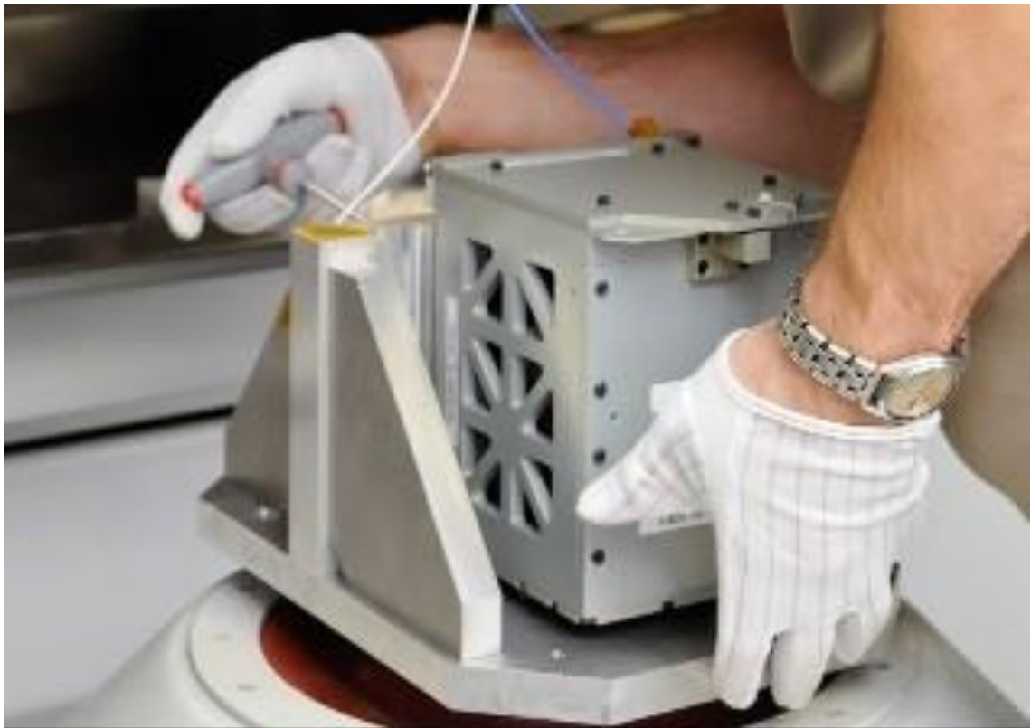
27. ábra Rázópad a Masat-1 vizsgálatához (forrás: [27])
