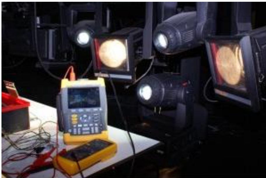
30. ábra A Masat-1 napelemeinek tesztelése az Operaház reflektoraival (forrás: [27])
