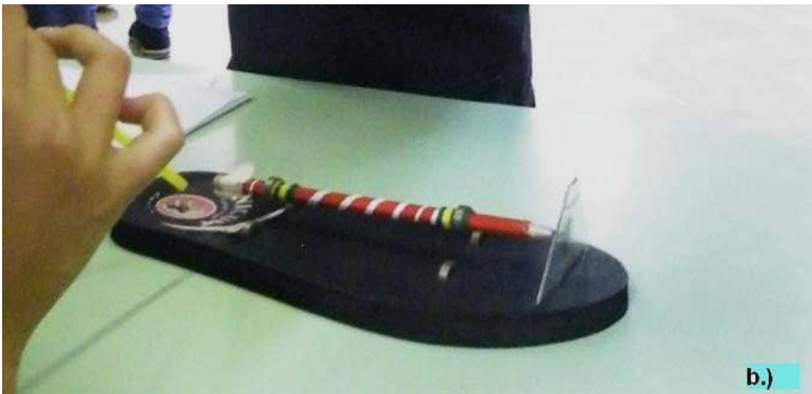
6.4.3. a-b. ábra: lebegő ceruza mágnes gyűrűkkel. A terv (a), és a megvalósítás (b).
