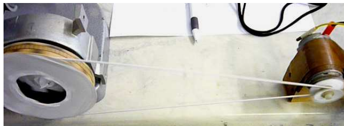
1.1.7. ábra. A szabályozható fordulatszámú motor szíjjátéttel hajtja meg az excenteres karral ellátott tárcsát.
