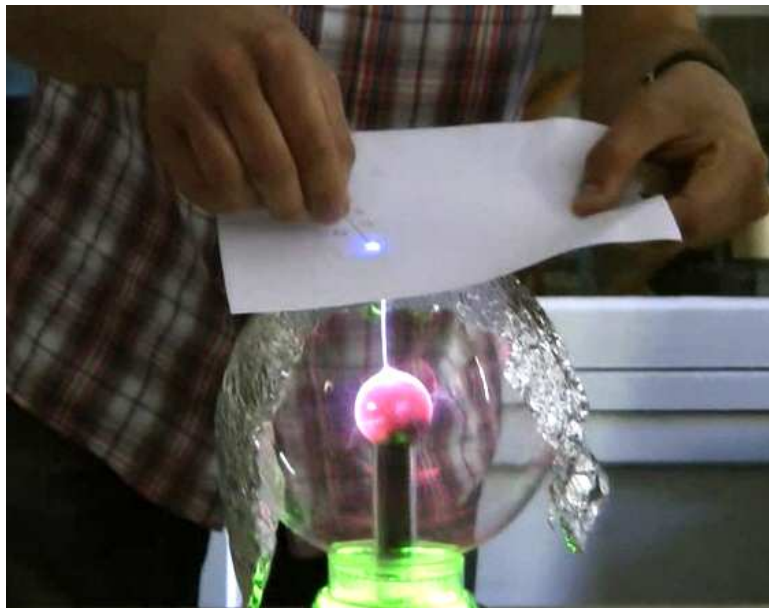
6.5.5. ábra. A plazmagömbre tett alufólia és papír kondenzátort alkot a földelt tüvel
