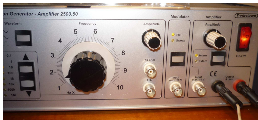
2.2.12. ábra. A szabályozható frekvenciájú, amplitúdójú rezgéseket előállító hangfrekvenciás generátor
