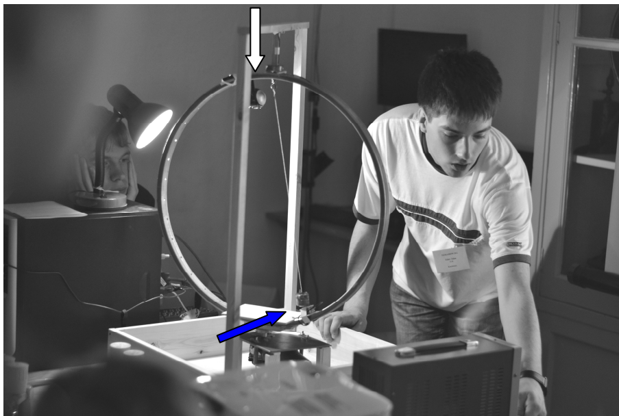
6.5.7. ábra. Diákkörösök saját fejlesztésű eszközével egy forgó rendszerben vezeték nélküli webkamerával és a WebCamLaboratory szoftverrel vizsgálja Fehér Ádám diákkörös tanuló (jelenleg a Kecskeméti Főiskola hallgatója) egy fonálinga lengését.
