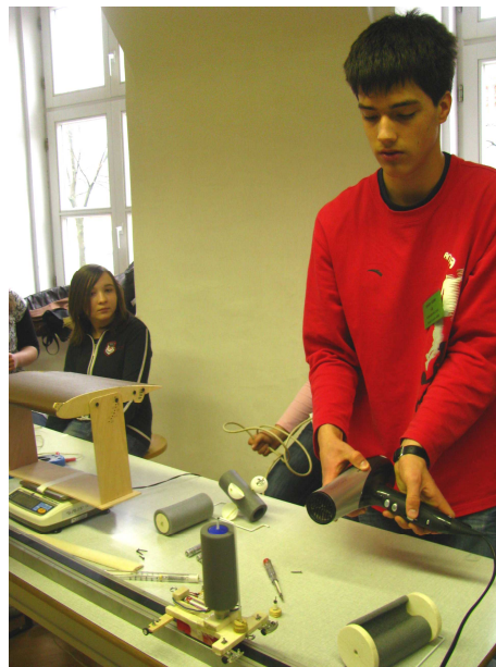
6.4.2. ábra. A diákkörös Ádám (Jelenleg a Kecskeméti Főiskola duális képzésében hallgató) Magnus-kocsija működés közben
