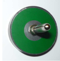
3.1.2. ábra. Az ingatestként használt mágnes korong 2,8cm átmérővel.
