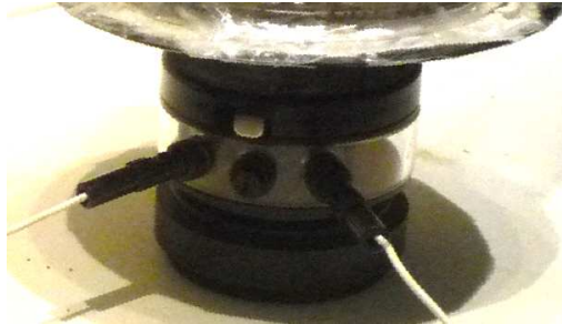
2.2.11. ábra. A rezgékeltő készülék, egy hangszóró membránjához rögzített fémlap.
