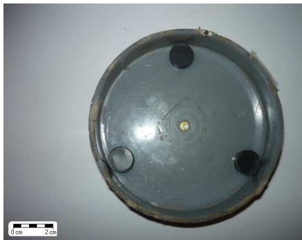
3.1.4. ábra. A háromszög alakzatban rögzített mágnes pogácsák távolsága kb. 6cm.
