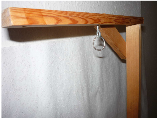
3.1.3. ábra. Az inga felfüggesztése. A szemcsavarba illesztett fémkarikához akasztjuk az inga pálcáját, így csak kis súrlódás lép fel a mozgás során.
