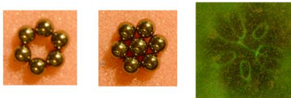
2.7 ábra Hat, illetve hét mágnes-golyó és ez utóbbi esetben kialakult mágneses tér. Világosan felismerhető, hogy a mágneses tér szimmetriája nem egyezik meg a golyók elhelyezkedésének szimmetriájával.
