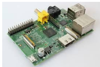
1.20 ábra A marokkói terepgyakorlaton részt vett szondabelső bonyolultsága, jobbra az ezt részben kiváltani hivatott bankkártya méretű Raspberry-PI
