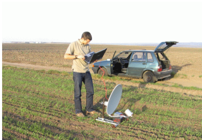
1.12 ábra A WLAN összeköttetés hatótávolságának ellenőrzése a terepen
