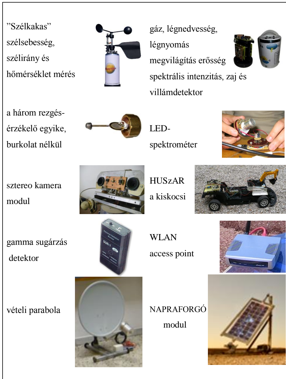
1.9 ábra A HUNVEYOR-4 néhány, részben a diákok által készített, részben az általuk rendszerbe illesztett fontosabb modulja, a teljesség igénye nélkül
