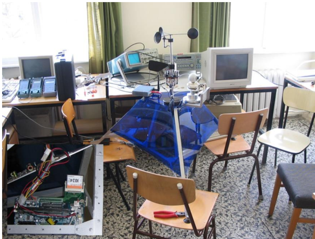
1.6 ábra A HUNVEYOR-4b szerelés közben. A bal alsó sarokban látható inzerben az új alaplap, tápegység és az operációs rendszert tartalmazó 1 GB-os flash memória látható.
