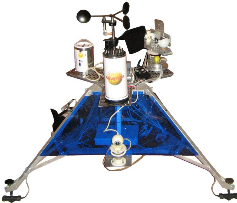
1.1 ábra A HUNVEYOR-4 űrszonda modell
