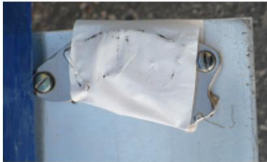
1.19 ábra A mágnesen (bal oldali kép) a sivatagi porból befogott vasszemcsék láthatók az elektronikán pedig rengeteg porszemcse gyűlt össze, valószínűleg elektrosztatikus feltöltődés következtében.
