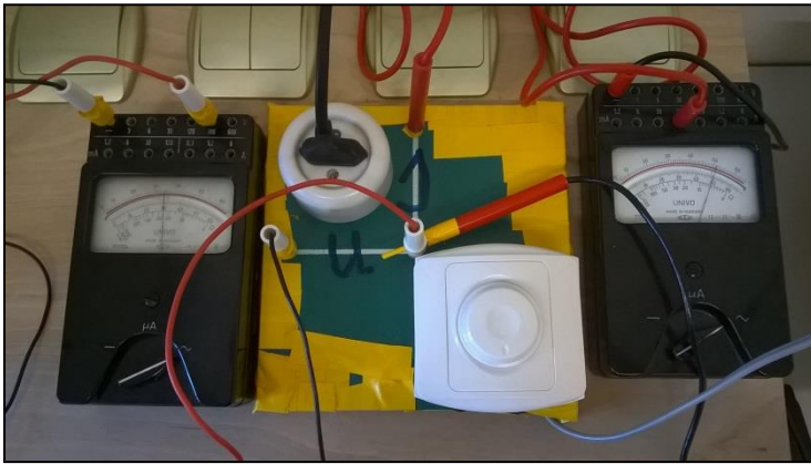
9. ábra Az összeállított áramkör a potenciométerrel és a mérőműszerekkel
