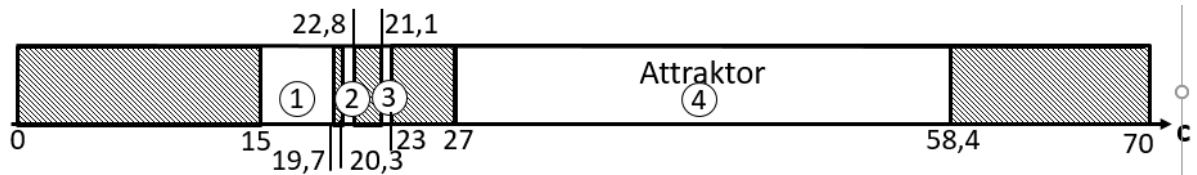
59. ábra A forgó mágneses teret jellemző c paraméter változásának hatása a kaotikus attraktor megjelenésére
