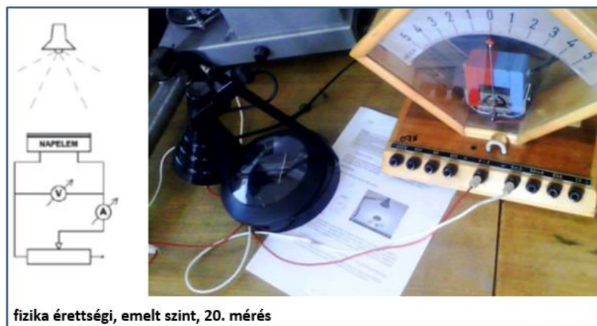
Napelem tesztelése, emelt szint, 20. mérés
