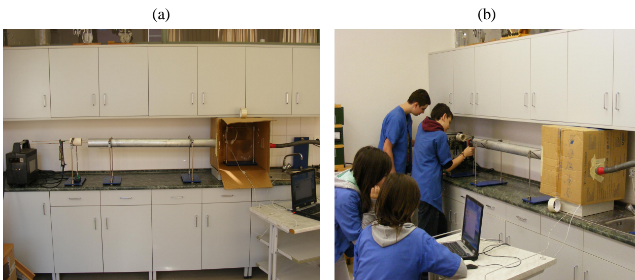
7.13. ábra (a) Elektromos árammal fűtött, vízszintes helyzetű Rijke-cső; (b) Tanulói mérés.
