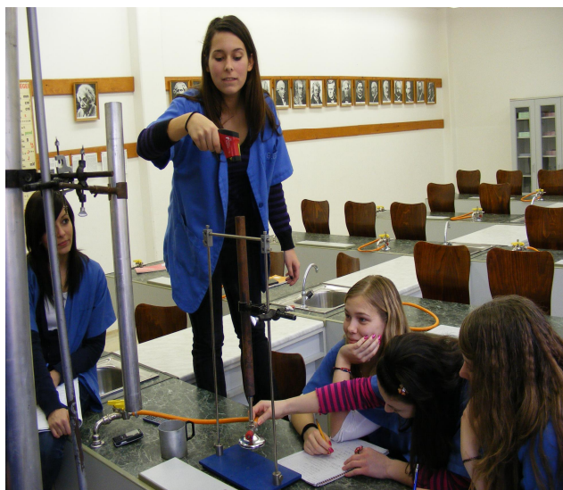
7.10. ábra Iskolánk tanulói méréseket végeznek gázzal fűtött Rijke-csővel.
