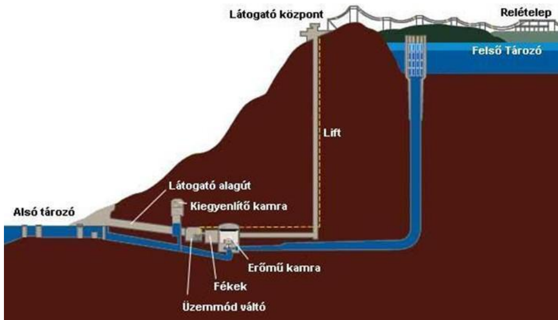
4.7 ábra: Szivattyús vízerőmű
