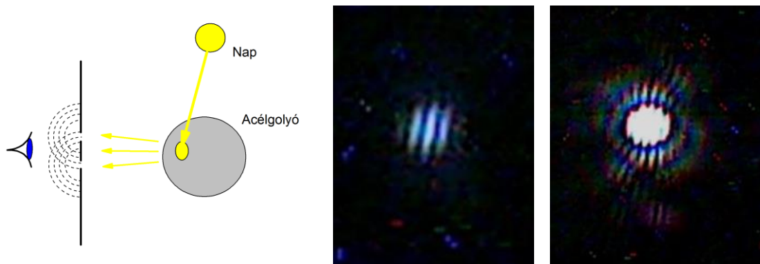
2.6. ábra: A kétlyukas interferencia egyéni megfigyelése. A Napot tükröző fényes foltot sötét csíkok mintázzák, a folt körül ugyancsak megfigyelhető a világos és sötét foltokból álló interferenciakép
