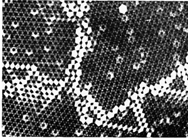
8. ábra. Az elegykristály modellje. A rácsot alkotó golyók méretétől alig eltérő ötvöző-golyók zavartalanul beépülnek a kristályrácsba
