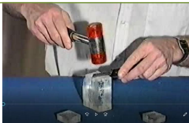
17.3. ábra: Kősókristály hasítása kockalapok mentén
