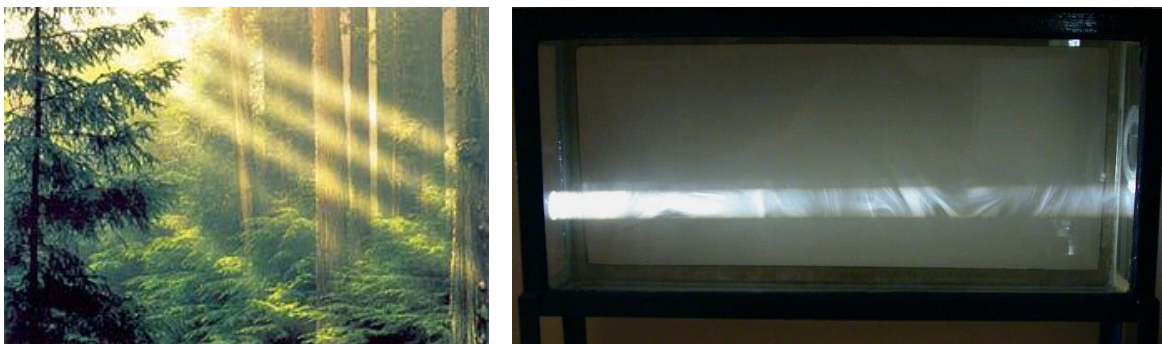
1.2. ábra: (bal) Napsugarak szóródása a levegőben lévő vízcseppeken és porszemeken, (jobb) füstszemcséken szóródó lámpafény
