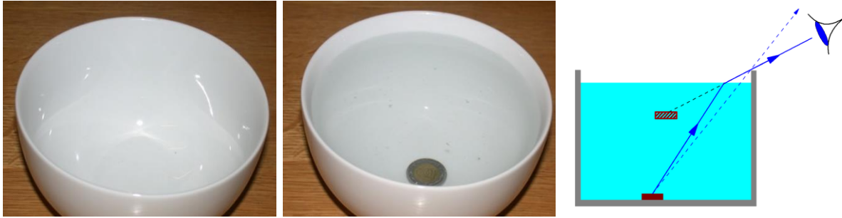
1.18. ábra: Az érme az üres tálban nem látható, a tálat vízzel feltöltve, képe láthatóvá válik; (jobb) az érméből kiinduló fénysugár útja
